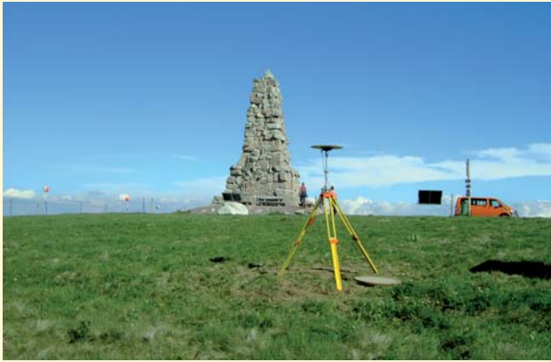
GPS-Messungen zur Punktbestimmung
